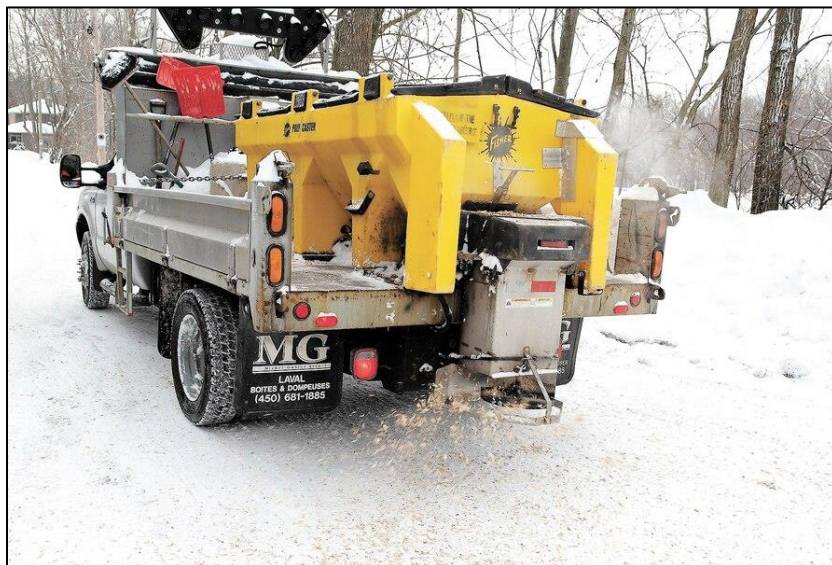
Figure 2. Épandage de copeaux de bois pour déglacer les rues (Dave Parent, 2018)
